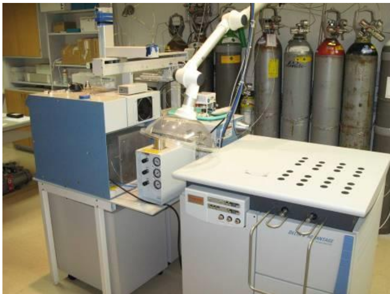
Joonis 5. Kergeste elementide H, C, N, O, S isotoopanalüüsi massispektromeeter Delta Advantage Thermo Fisher Scientific TTÜ geoloogia instituudi laboratooriumis.
