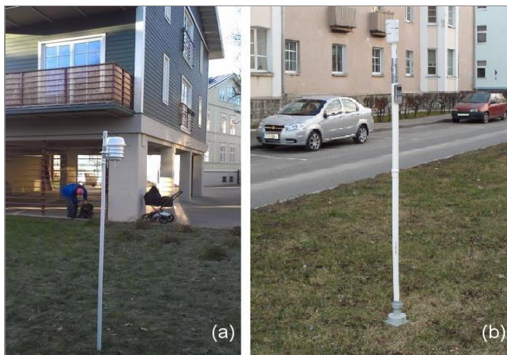
Joonis 1. Püsिमõõtmistel (a) ja marsruutmõõtmistel (b) kasutatud mõõtepost.
