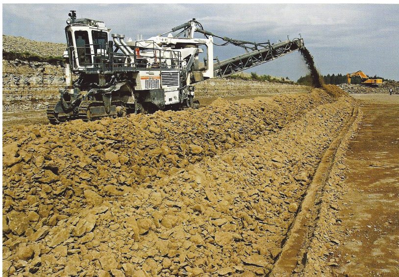
Fig. 5. Wirtgen 2500 SM surface miner in the Põhja-Kiviõli opencast. Photo by Heikki Bauert.
